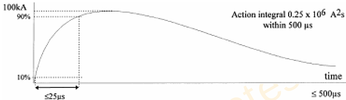
图20A 雷电流分量D单向指数波形 (适用直接效应试验)
