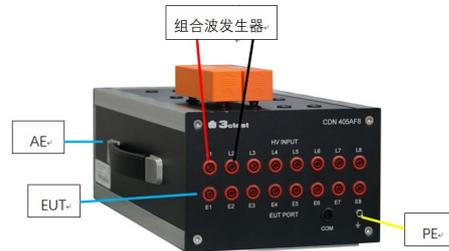
测试连接示意图 2 (线对地测试):
