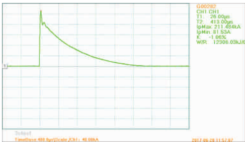
▲ 发生器实际测试200 kA的10 / 350µs波形
