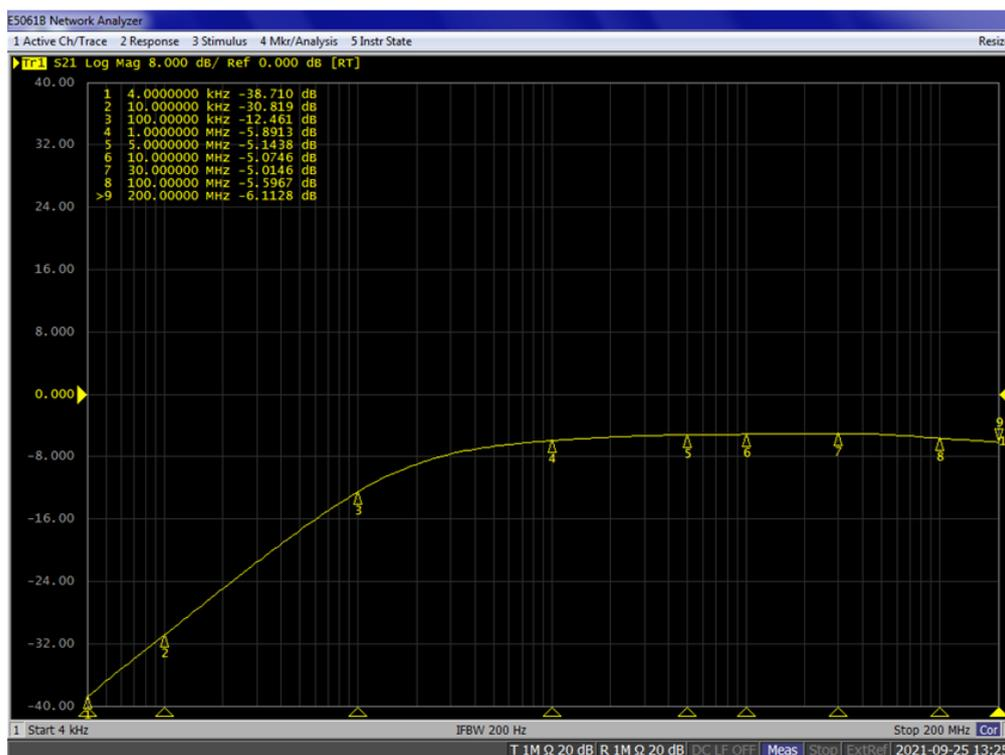
BCIP-200 电流注入钳插入损耗曲线
