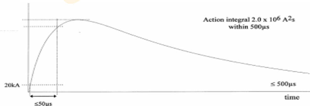
图14B 雷电流分量A单向指数波形 (适用直接效应试验)
