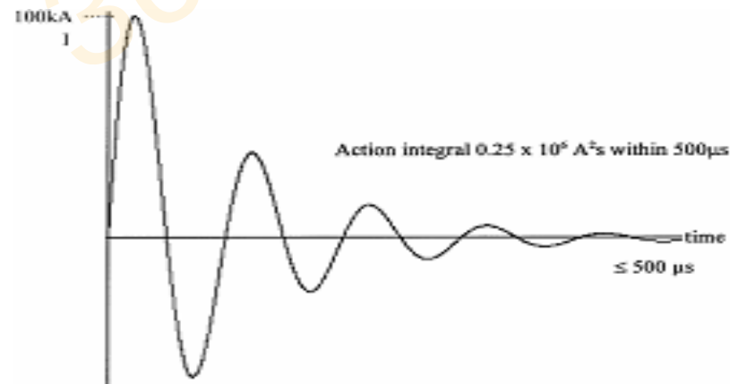
图20B 雷电流分量D正弦阻尼波形 (适用直接效应试验)
