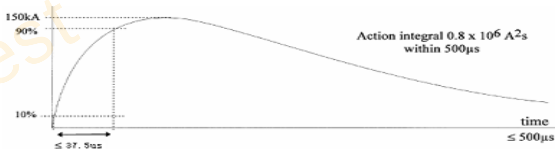
图16B 雷电流分量Ah单向指数波形 (适用直接效应试验)
