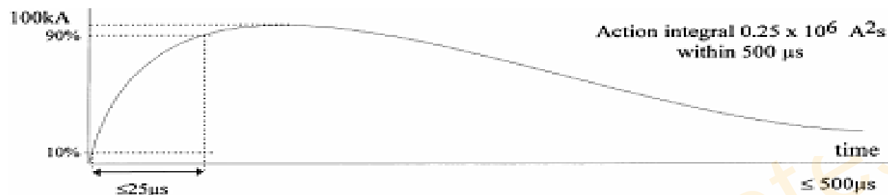
图20A 雷电流分量D单向指数波形 (适用直接效应试验)
