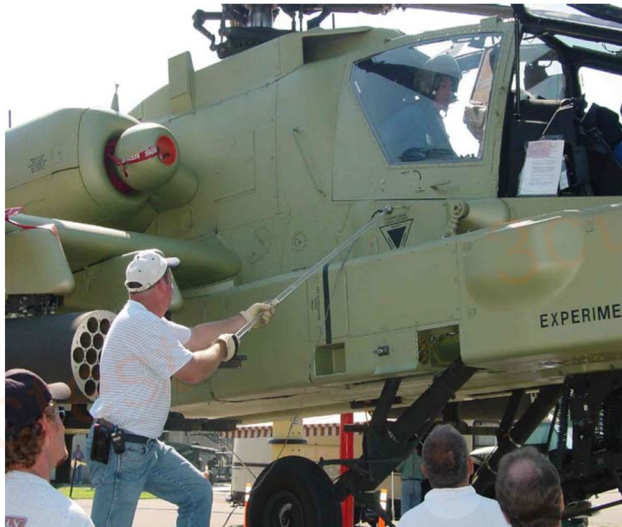
图7 试验现场照片——泄放机体残余静电荷
