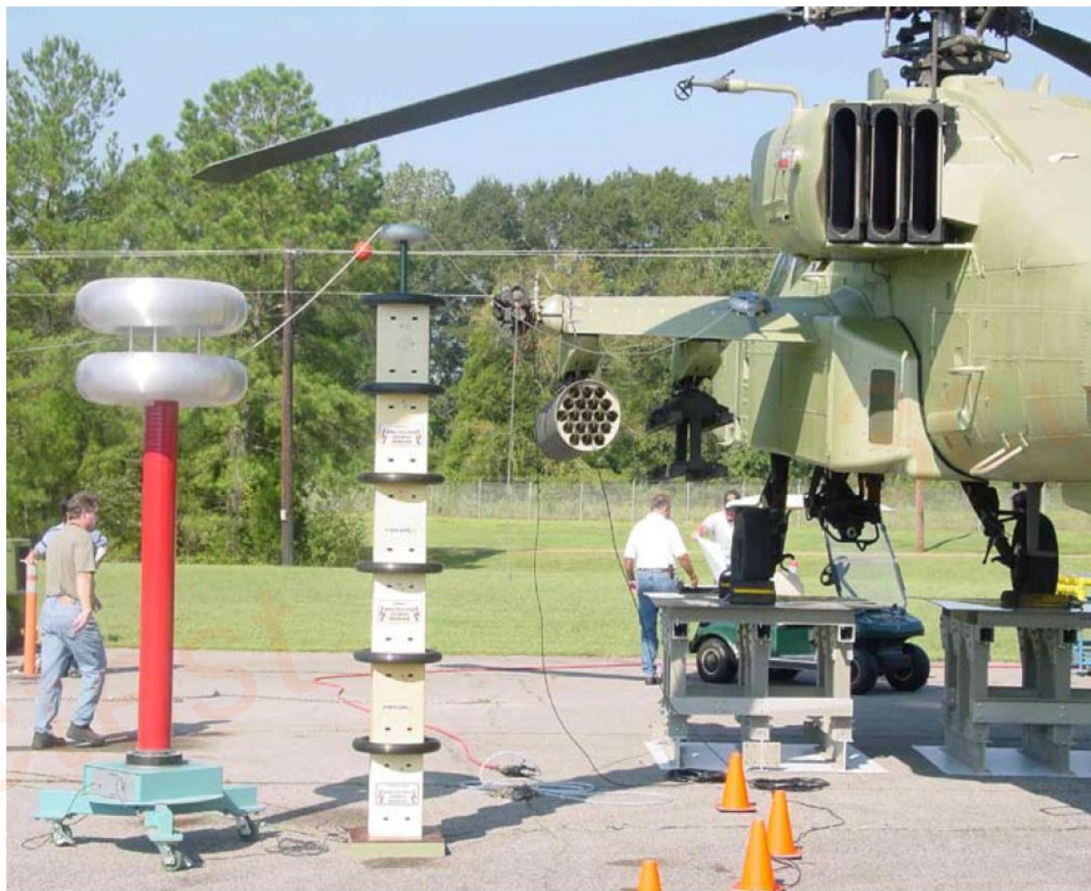
图5 飞机级沉积静电试验现场照片（通过专用注入环充电）
