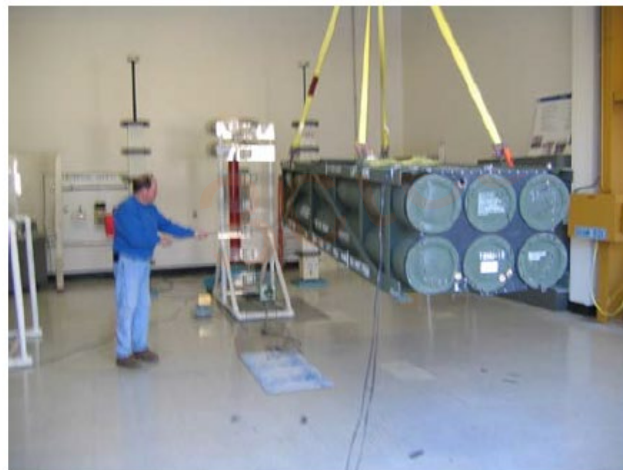
图9 垂直起吊/空中补给（卸载） ESD试验现场照片
