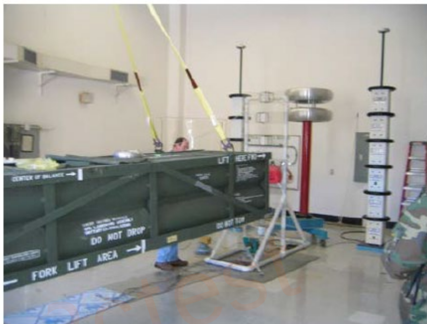
图9 垂直起吊/空中补给（卸载） ESD试验现场照片
