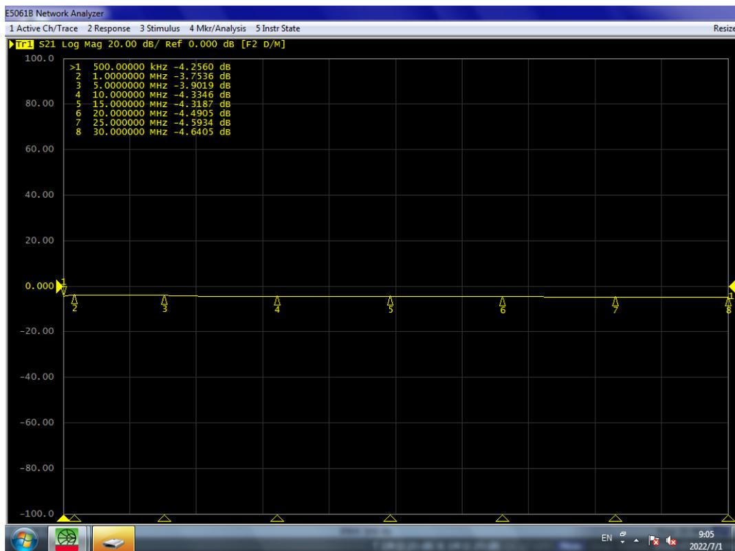
图 EMCL 5000 电磁耦合夹 s21 曲线
