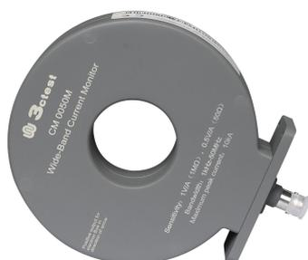
CM 0050M宽带电流监测钳用于1kHz-50MHz交变电流及时域脉冲电流的测量。通过电磁耦合方式将时谐信号电流或脉冲信号电流以电压方式传递给记录设备，具有波形无畸变、与电流载体物理隔离等特点。满足各类标准对50MHz及以下时谐信号、上升时间大于7ns瞬态脉冲信号的测量需求。广泛应用于电磁兼容传导敏感度（抗扰度）测试。
